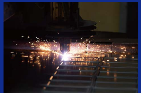
プラズマ切断
